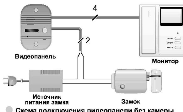
Схема подключения видеопанели без камеры к монитору и видеокамере
