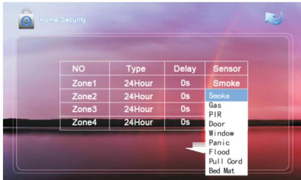
Когда сработает любой из датчиков, установленных на любом из активных шлейфов, то на внутреннем мониторе будет отображен номер сработавшего шлейфа, название подключенных датчиков и выведен сигнал на сирену.
