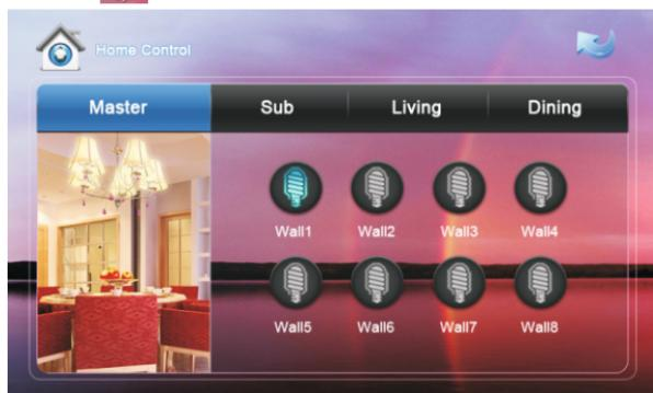
Для управления светом доступно четыре комнаты и восемь каналов света в каждой комнате. Для включения света необходимо нажать на кнопку включения соответствующего канала, а для отключения нажать на эту кнопку еще раз.
