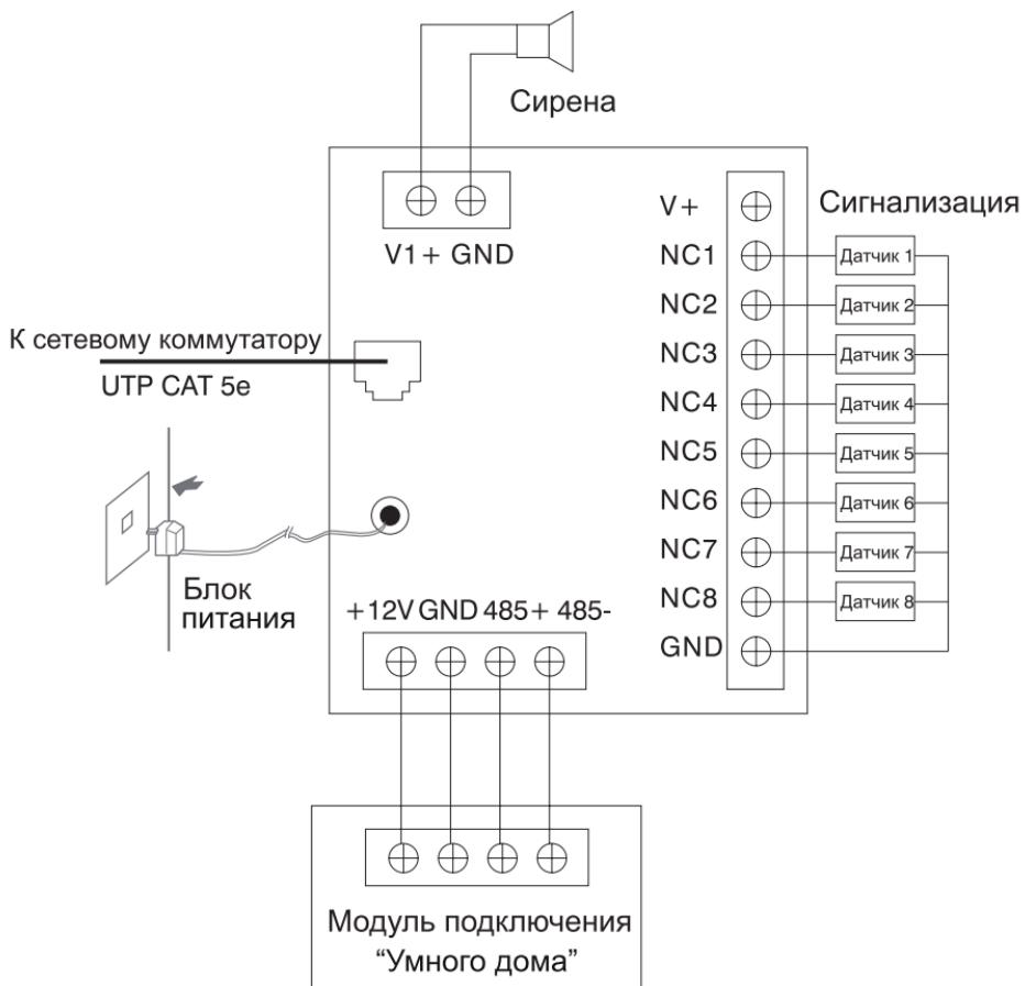
Подключение разъемов на задней стенке внутреннего монитора.
